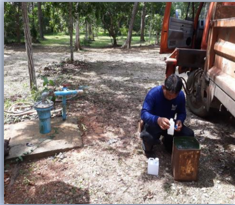
รูปภาพขณะเก็บตัวอย่างน้ำในบ่อก่อนและหลังเป่าล้าง
