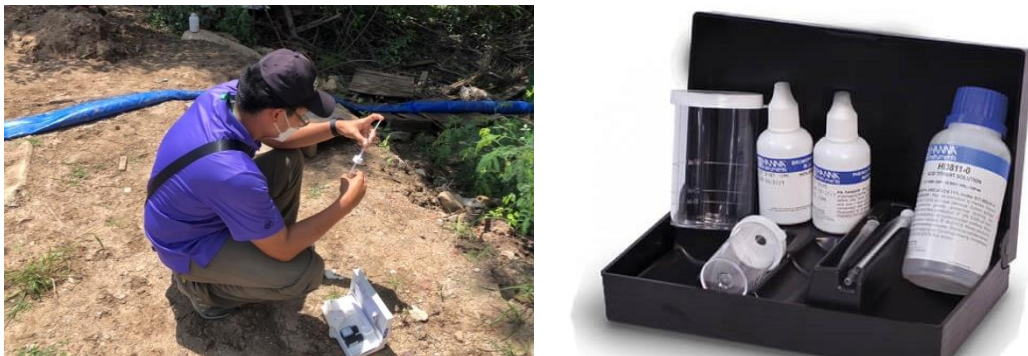
รูปที่ 4-92 การทดสอบเพื่อวัดค่ากรดต่างของน้ำ โดยอาศัยชุดทดสอบ alkalinity test kit
