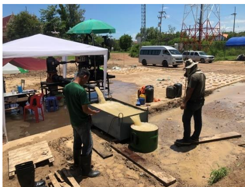
(ช) การตรวจสอบปริมาณอัตราการสูบน้ำ ด้วยวิธีวัดตรงปริมาณน้ำเทียบกับเวลา
