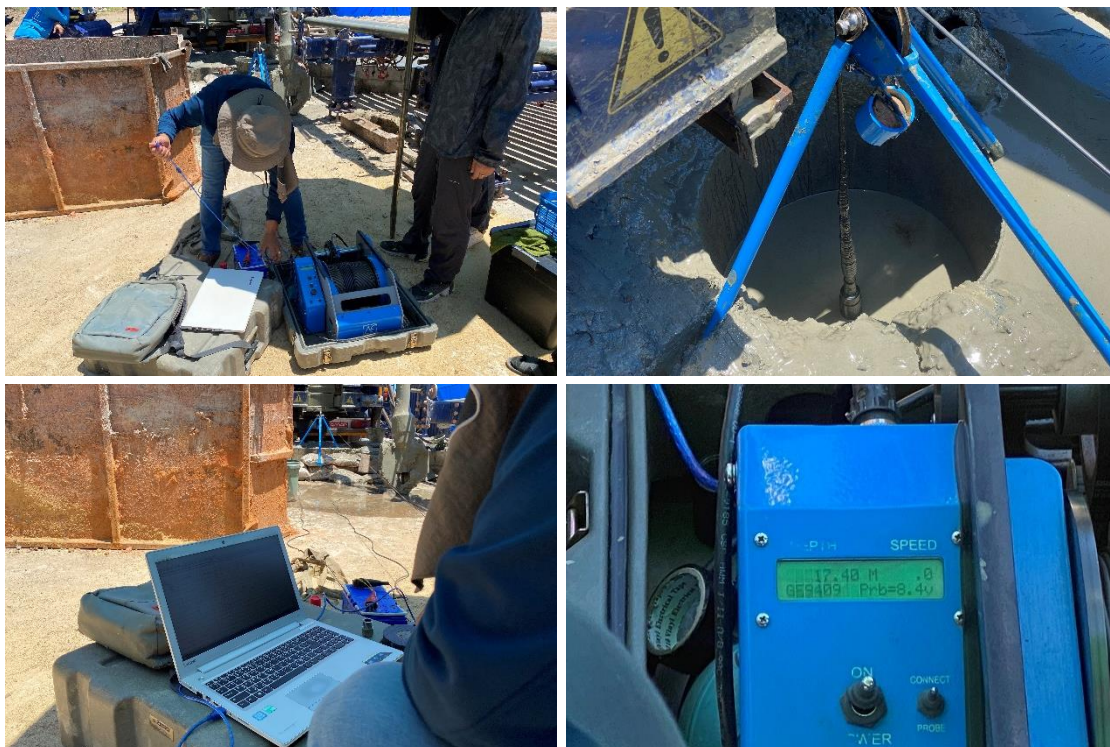
รูปที่ 4-51 (ก)-(ง) ขั้นตอนการปฏิบัติงานหยั่งธรณีฟิสิกส์หลุมเจาะ ช่วงความลึก 0-18 เมตร
