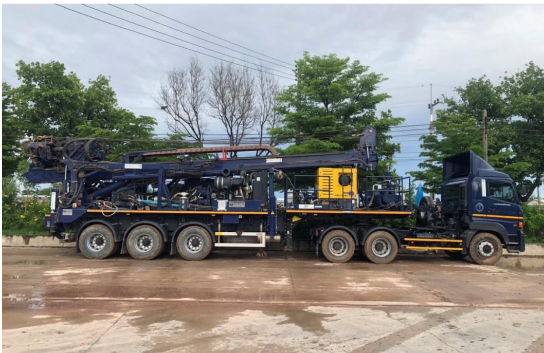
รูปที่ 4-24 เครื่องเจาะบ่อน้ำบาดาล ยี่ห้อ MASSENZA รุ่น MI 45
