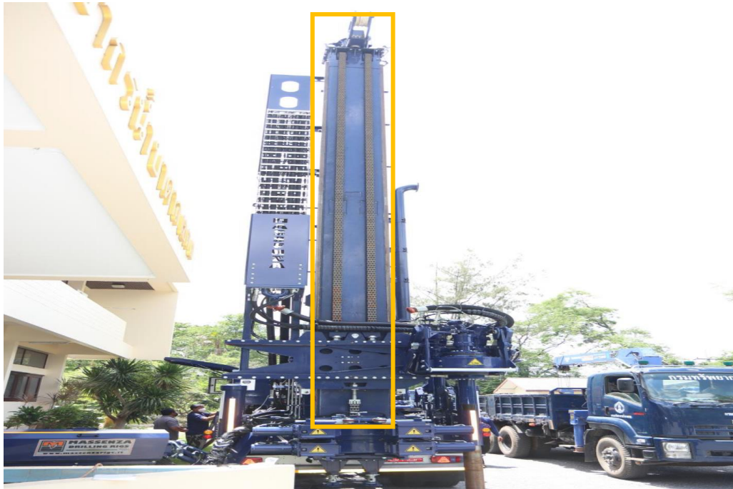
รูปที่ 4-30 เสากะโด้ง (Drill Mast)
