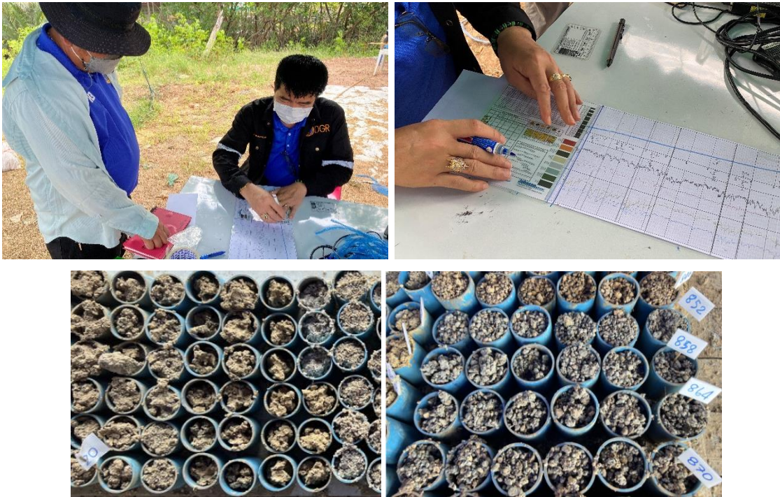
รูปที่ 4-56 การคัดเลือกชั้นน้ำ โดยอาศัยข้อมูลธรณีวิทยาและธรณีฟิสิกส์หลุมเจาะ
