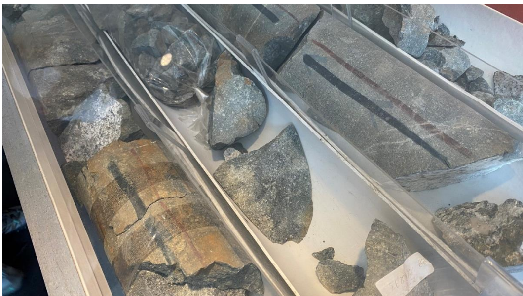
รูปที่ 10 แท่งตัวอย่างหินแอนดีไซต์ จากบ่อ KMJ-80 ที่ระดับความลึก 1,281.66 ถึง 1,283.80 เมตร
