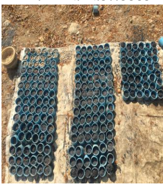
ตัวอย่างชั้นดินชั้นหินที่ได้จากหลุมเจาะ
