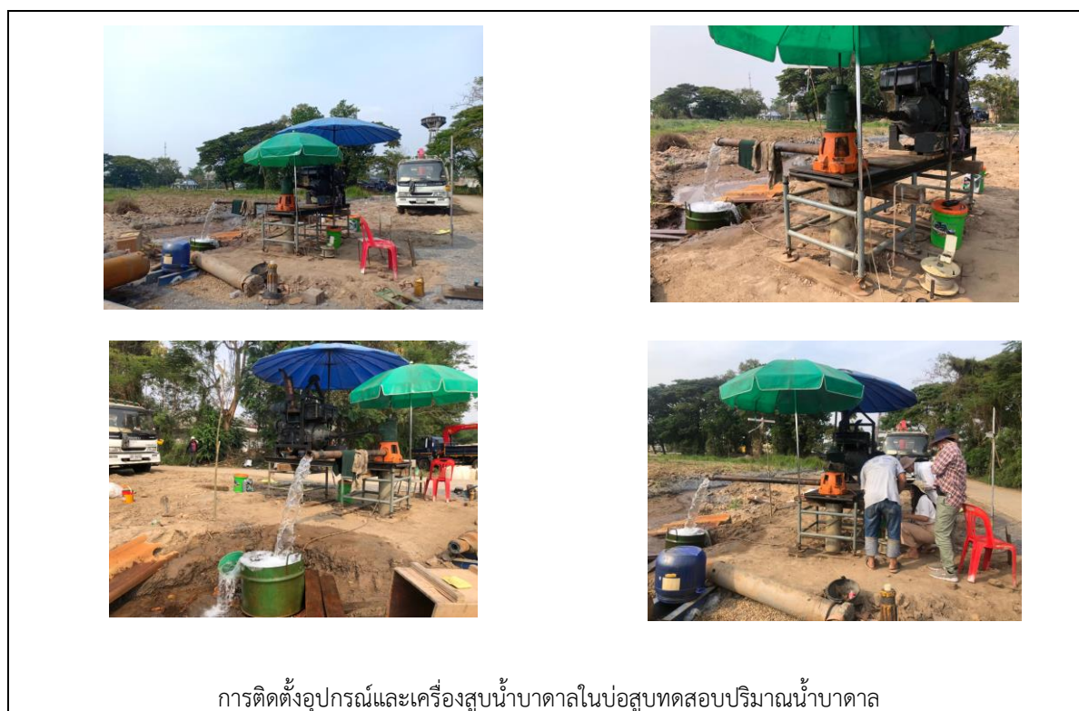
รูปที่ 2-13 แสดงขั้นตอนการปฏิบัติงานสูบน้ำบาดาลในภาคสนาม
