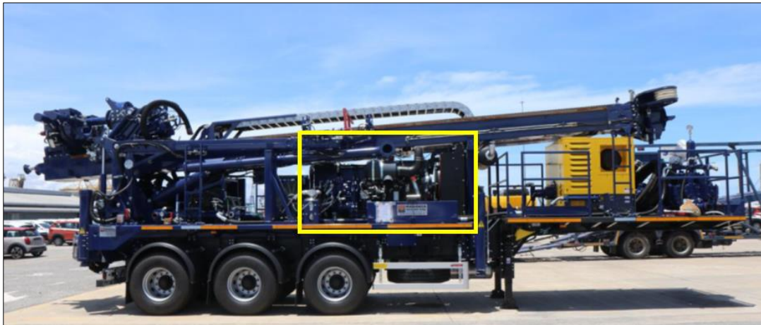
รูปที่ 5-3 เครื่องยนต์ต้นกำลังของเครื่องขุดเจาะบ่อน้ำบาดาล
