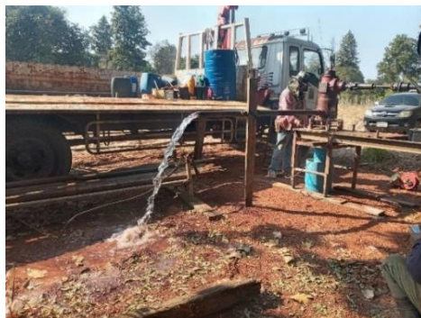
(ช) การตรวจสอบปริมาณอัตราการสูบน้ำด้วยวิธี วัดตวงปริมาณน้ำเทียบกับเวลา
