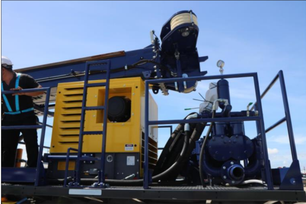
รูปที่ 5-12 เครื่องอัดอากาศ
