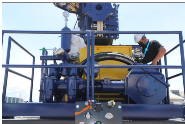
รูปที่ 5-5 ปั๊มสูบน้ำโคลนแบบลูกสูบชัก ชนิด 2 สูบ (Duplex Piston Pump)
