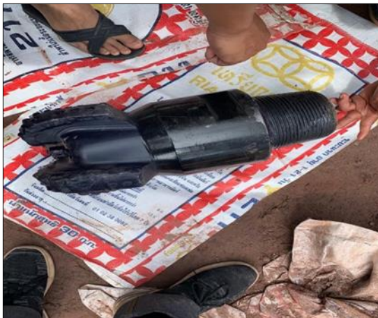
ช. เจาะสำรวจด้วยระบบน้ำโคลน หัวเจาะ PDC ขนาด 8 1/2 นิ้ว ที่ความลึก 918- 1,014 เมตร
