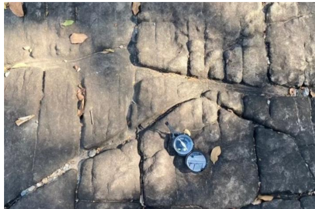
รูปที่ 4-4 เข็มทิศธรณีวิทยา แบบ Brunton type
