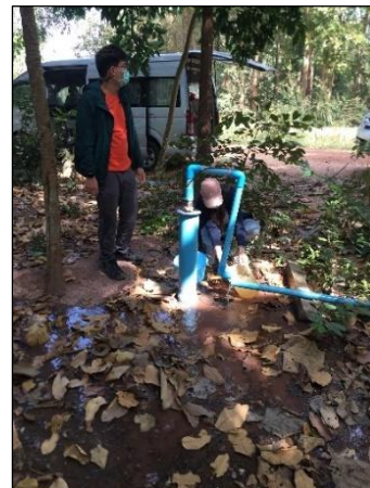
รูปที่ 4-67 การเก็บตัวอย่างน้ำเพื่อการวิเคราะห์ไอโซโทปเสถียร
