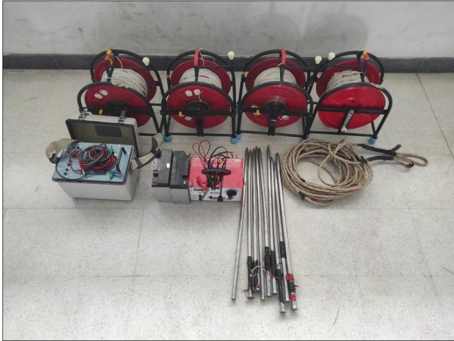
รูปที่ 4-15 เครื่องมือสำรวจวัดค่าความต้านทานไฟฟ้าแบบหยั่งลึก
