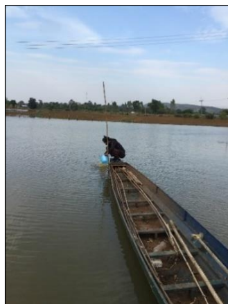
รูปที่ 4-67 การเก็บตัวอย่างน้ำเพื่อการวิเคราะห์ไอโซโทปเสถียร
