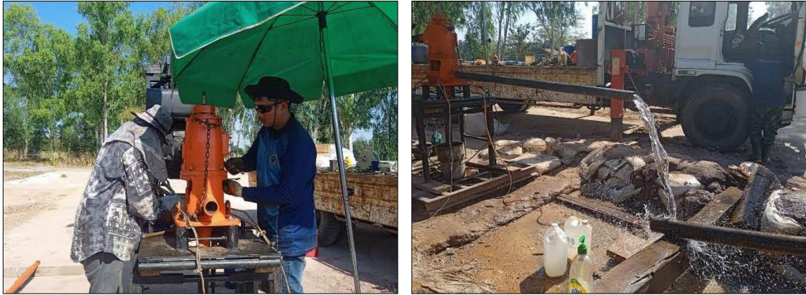
รูปที่ 4-55 การปฏิบัติงานสูบทดสอบปริมาณน้ำบาดาล บ้านหินขาว ตำบลสาวะถี อำเภอเมือง จังหวัดขอนแก่น
