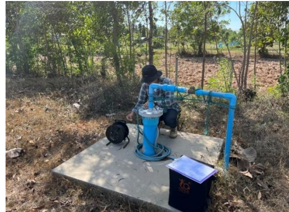
รูปที่ 4-62 การเก็บตัวอย่างน้ำบาดาลและน้ำผิวดินเพื่อการวิเคราะห์คุณภาพน้ำทางเคมีแบบสมบูรณ์
