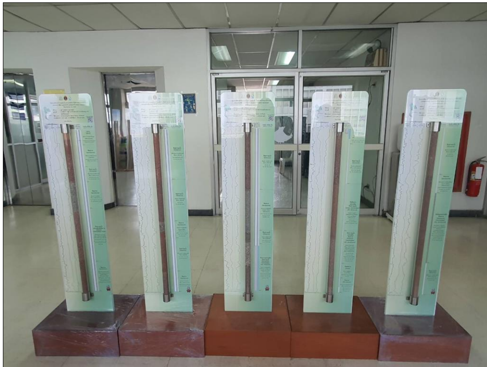
รูปที่ 4-51 แสดงตัวอย่างชั้นดินชั้นหิน บ่อเจาะสำรวจระดับลึก 1,000 เมตร
