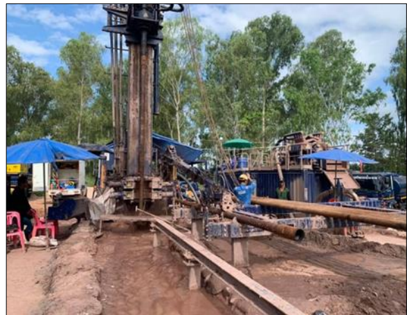
ช. เจาะสำรวจด้วยระบบน้ำโคลน หัวเจาะ PDC ขนาด 8 1/2 นิ้ว ที่ความลึก 918- 1,014 เมตร
