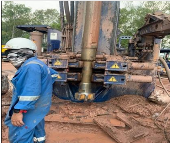
ฉ. เจาะสำรวจด้วยระบบน้ำโคลน หัวเจาะ Roller Rock Bit ขนาด 8 1/2 นิ้ว ที่ความลึก 870- 918 เมตร
