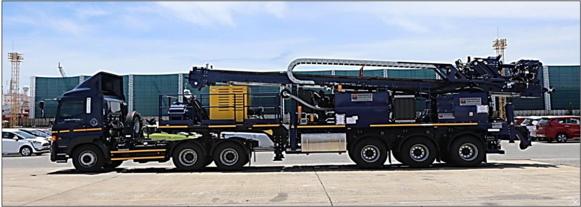
(ก) รถเจาะบ่อน้ำบาดาล ประเภทเครื่องเจาะผสมแบบใช้น้ำและลม
