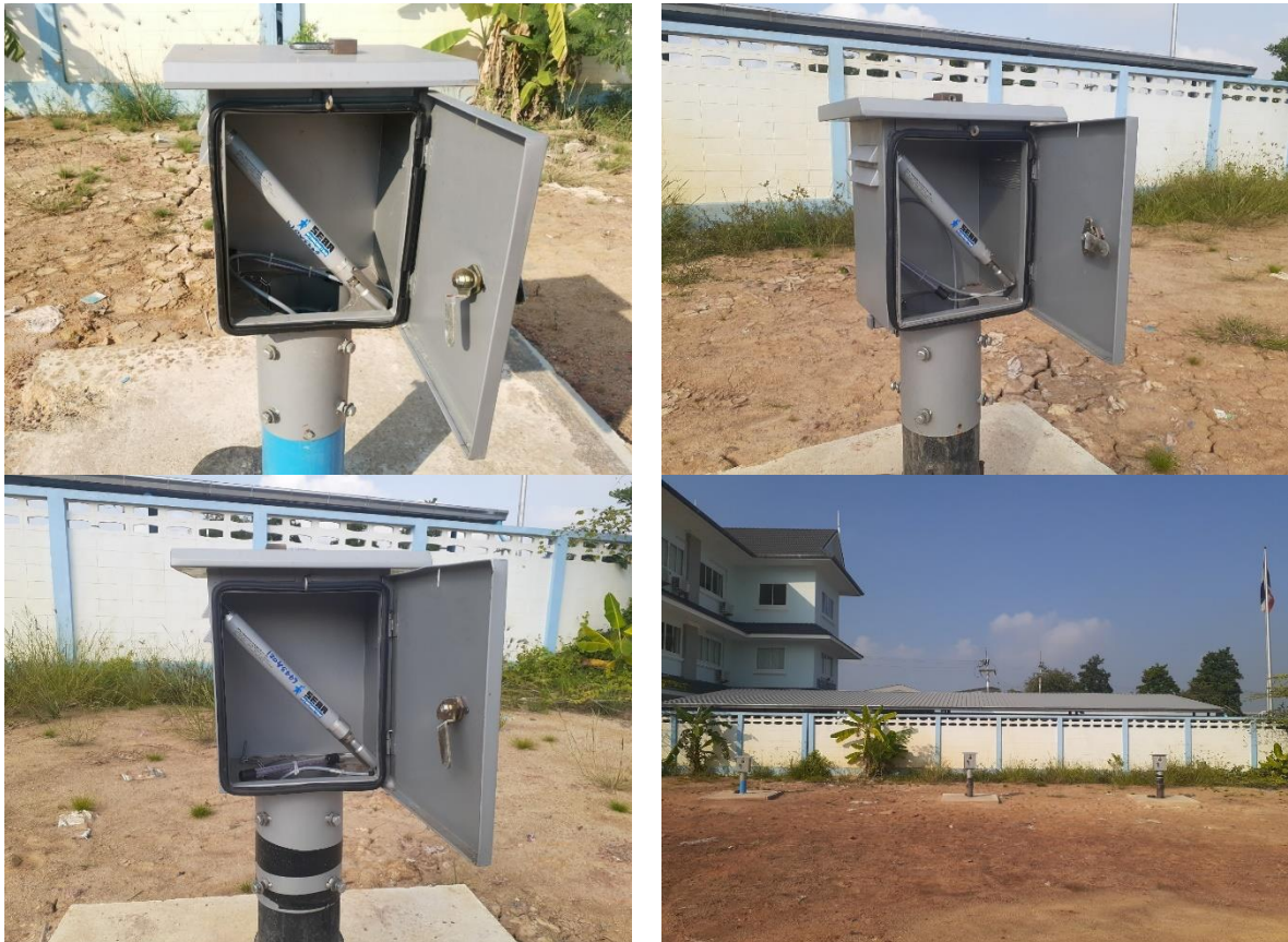
รูปที่ 3-16 การติดตั้งเครื่องบันทึกระดับน้ำและคุณภาพน้ำบาดาลอัตโนมัติในบ่อสังเกตการณ์ทั้ง 3 บ่อ
