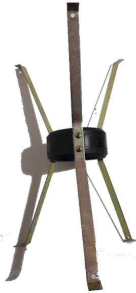
รูปที่ 5-7 ลักษณะอุปกรณ์วัดแรงดันน้ำใต้ดิน Vibrating Wire Piezometer
