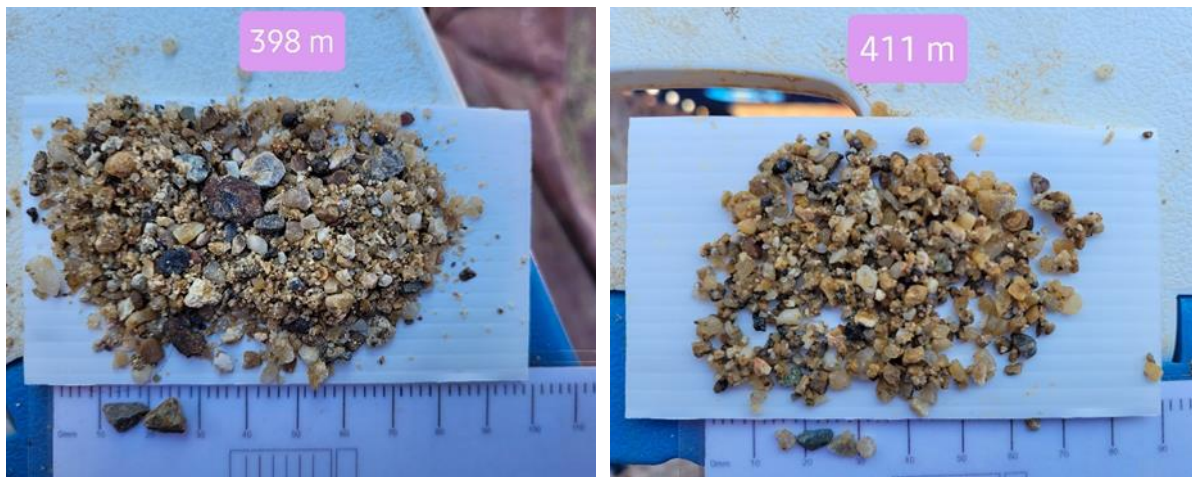
รูปที่ 3-11 ตัวอย่างชั้นดิน-หิน จากหลุมเจาะ ที่ระยะ 398 เมตร และ 411 เมตร พบเป็นทราย ขนาดหยาบ กรวดขนาด 2-3 มิลลิเมตรผสมอยู่
