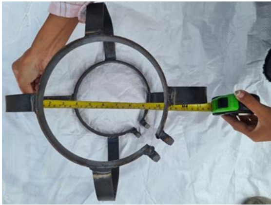
รูปที่ 3-3 โครงบังคับท่อ (centralizer of groundwater well) ใส่ที่ปลายท่อรับทราย และเหนือท่อเจาะ ร่องท่อนบนสุด
