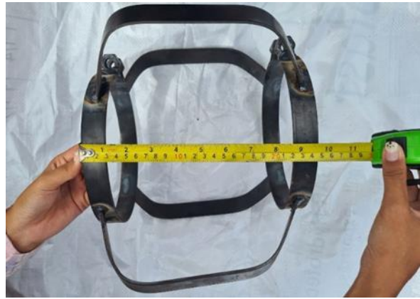
รูปที่ 3-3 โครงบังคับท่อ (centralizer of groundwater well) ใส่ที่ปลายท่อรับทราย และเหนือท่อเจาะ ร่องท่อนบนสุด
