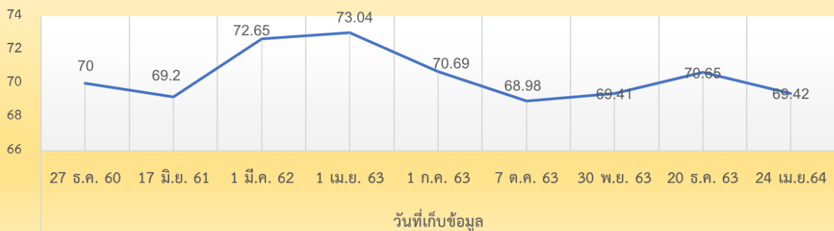
รูปที่ ค-3 กราฟแสดงระดับน้ำบาดาล บ่อหมายเลข 6108A017 ความลึกพัฒนา 287 เมตร ระยะท่อเจาะร่อง 275-281 เมตร
