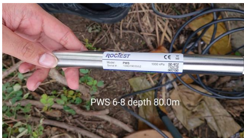
รูปที่ 5-6 ลักษณะอุปกรณ์วัดแรงดันน้ำใต้ดิน Vibrating Wire Piezometer
