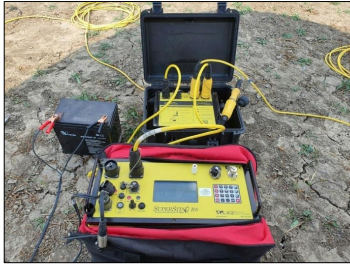
ภาพที่ 3-9 เครื่องมือและอุปกรณ์ที่ใช้ในการสำรวจธรณีฟิสิกส์ 2 มิติ
