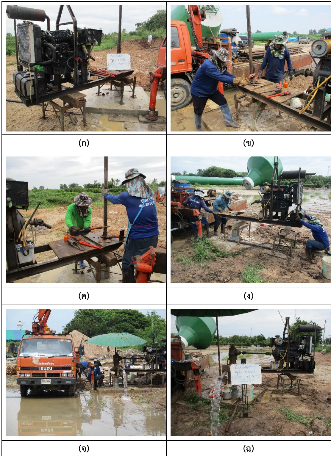
ภาพที่ 3- 18 (ก-ฉ) ภาพแสดงขั้นตอนการปฏิบัติงานสูบน้ำทดสอบปริมาณน้ำบาดาลในภาคสนาม บ้านหนองศาลา หมู่ที่ 3 ตำบลดิ่งชัน อำเภอเมืองสุพรรณบุรี จังหวัดสุพรรณบุรี
