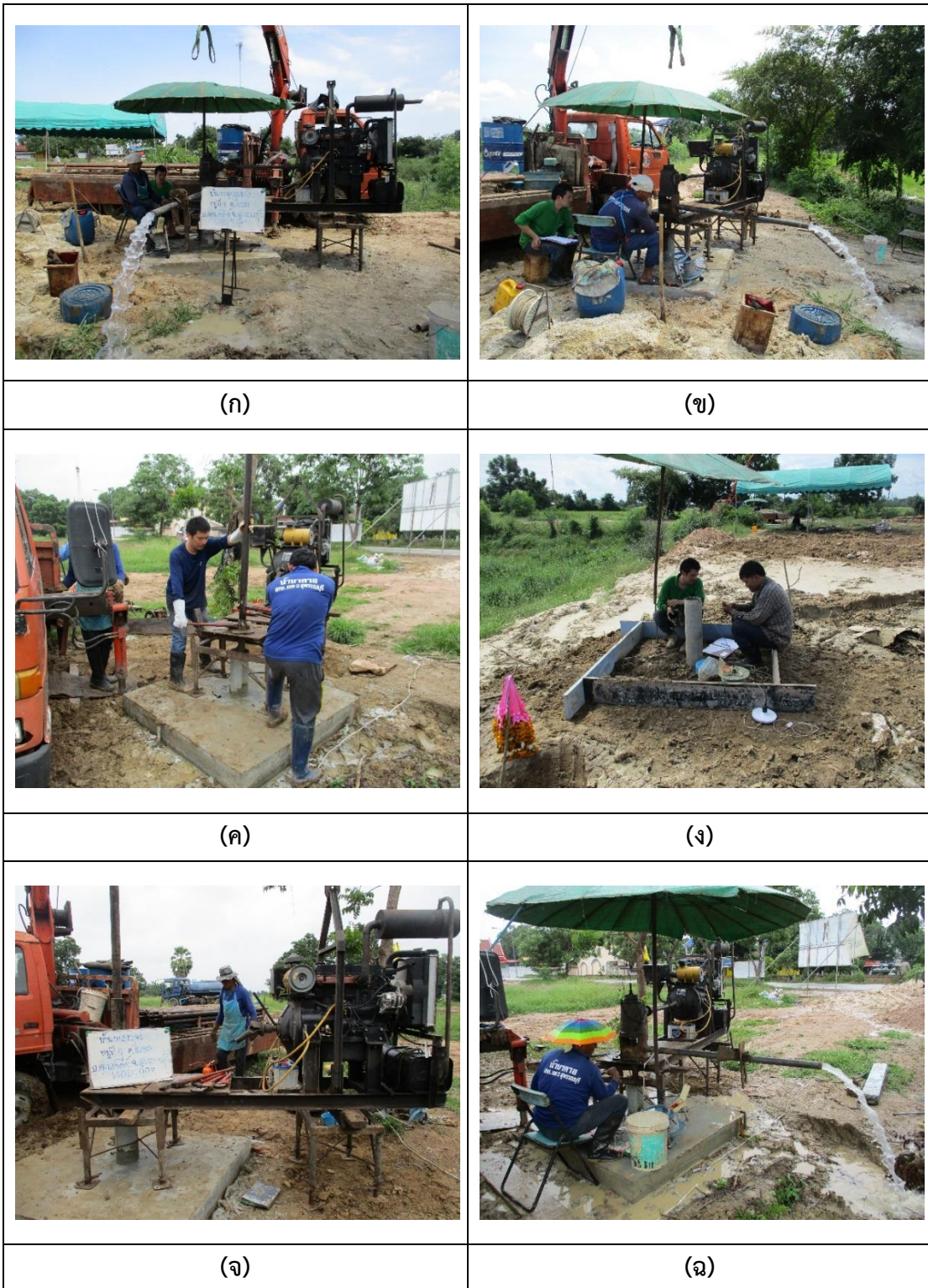
ภาพที่ 3- 20 (ก-ฉ) ภาพแสดงขั้นตอนการปฏิบัติงานสูบทดสอบปริมาณน้ำบาดาลในภาคสนาม บ้านหนองแจงหมู่ที่ 4 ตำบลไร่รถ อำเภอดอนเจดีย์ จังหวัดสุพรรณบุรี
