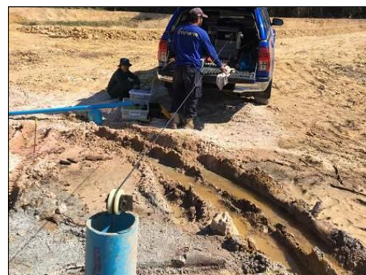
รูปที่ 3.20 การหยั่งธรณีหลุมเจาะ บริเวณ ต.สนามไชย อ.นายายอาม จ.จันทบุรี
