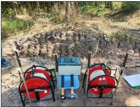
รูปที่ 3.5 เครื่องมือและอุปกรณ์ที่ใช้ในการสำรวจวัดค่าความต้านทานไฟฟ้าของชั้นดินชั้นหินแบบหยั่งลึก
