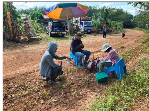
รูปที่ 3.6 การสำรวจธรณีฟิสิกส์ด้วยการสำรวจวัดค่าความต้านทานไฟฟ้าของชั้นดินชั้นหินแบบหยั่งลึก
