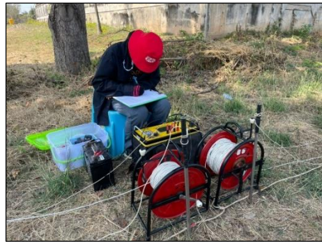
รูปที่ 3.5 เครื่องมือและอุปกรณ์ที่ใช้ในการสำรวจวัดค่าความต้านทานไฟฟ้าของชั้นดินชั้นหินแบบหยั่งลึก
