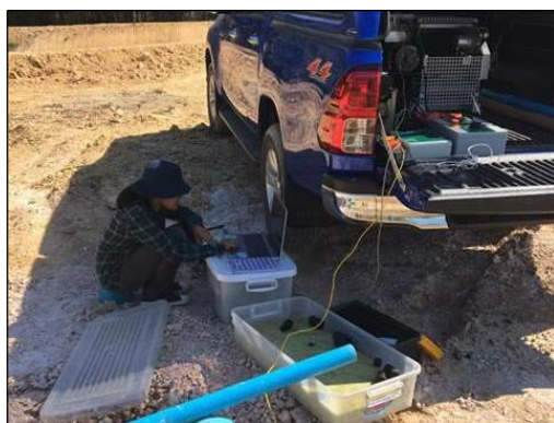
รูปที่ 3.20 การหยั่งธรณีหลุมเจาะ บริเวณ ต.สนามไชย อ.นายายอาม จ.จันทบุรี
