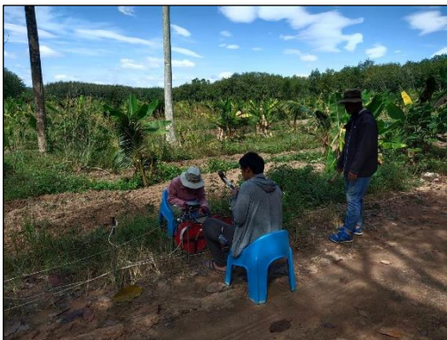
รูปที่ 3.6 การสำรวจธรณีฟิสิกส์ด้วยการสำรวจวัดค่าความต้านทานไฟฟ้าของชั้นดินชั้นหินแบบหยั่งลึก
