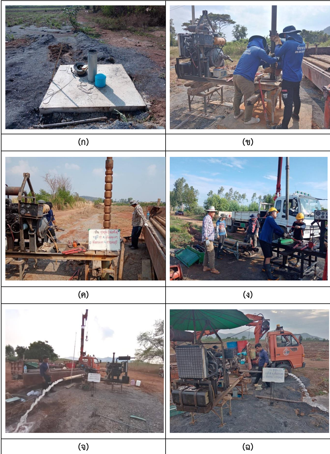
ภาพที่ 3- 22 ภาพแสดงขั้นตอนการปฏิบัติงานสุบทดสอบปริมาณน้ำบาดาลในภาคสนาม บ้านพยอมงาม หมู่ 12 ตำบลห้วยกระเจา อำเภอบัวลาย จังหวัดกาญจนบุรี
