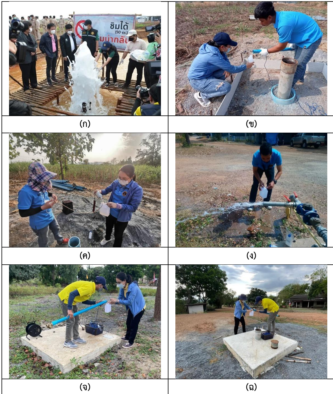
ภาพที่ 3- 31 (ก-ฉ) การเก็บตัวอย่างนํ้าบาดาล เพื่อดำเนินการวิเคราะห์ในห้องปฏิบัติการทางวิทยาศาสตร์
