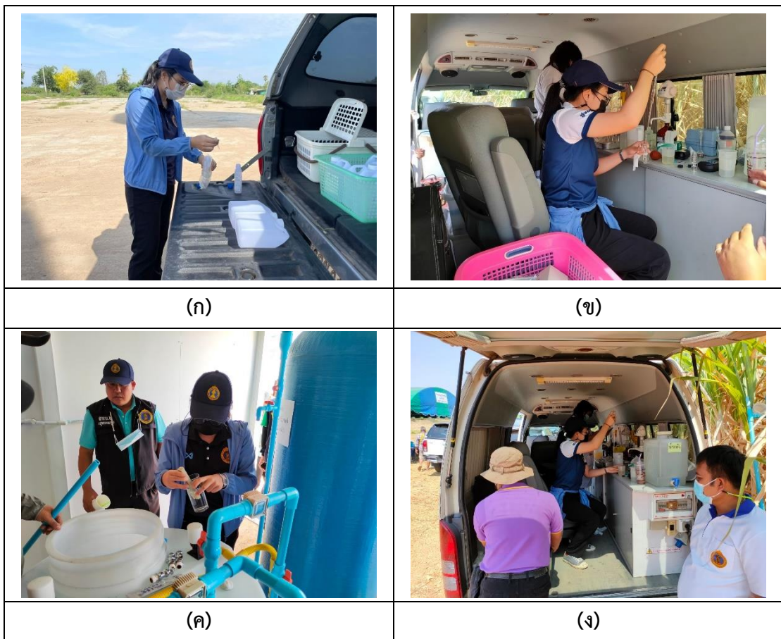
ภาพที่ 3- 32 (ก-ง) การรักษาสภาพตัวอย่างน้ำด้วยการหยดกรดไนตริก 1:1 จำนวน 1 มิลลิลิตรต่อตัวอย่างน้ำ 250 มิลลิลิตร และการวิเคราะห์คุณภาพบํานาน้ำบาดาลภาคสนาม
