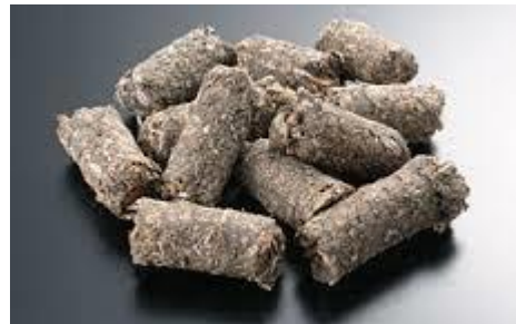
รูปที่ 12 ตัวอย่างเชื้อเพลิงที่ได้จากการแปรรูปขยะพลาสติก
