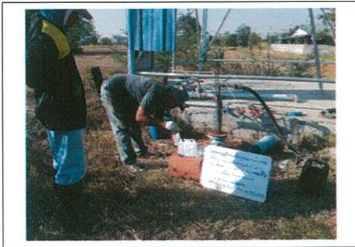
6.ภาพขวดตัวอย่างน้ำบาดาลที่จะส่งวิเคราะห์ พร้อมสติ๊กเกอร์ที่ติดข้างขวดเรียบร้อยแล้ว
