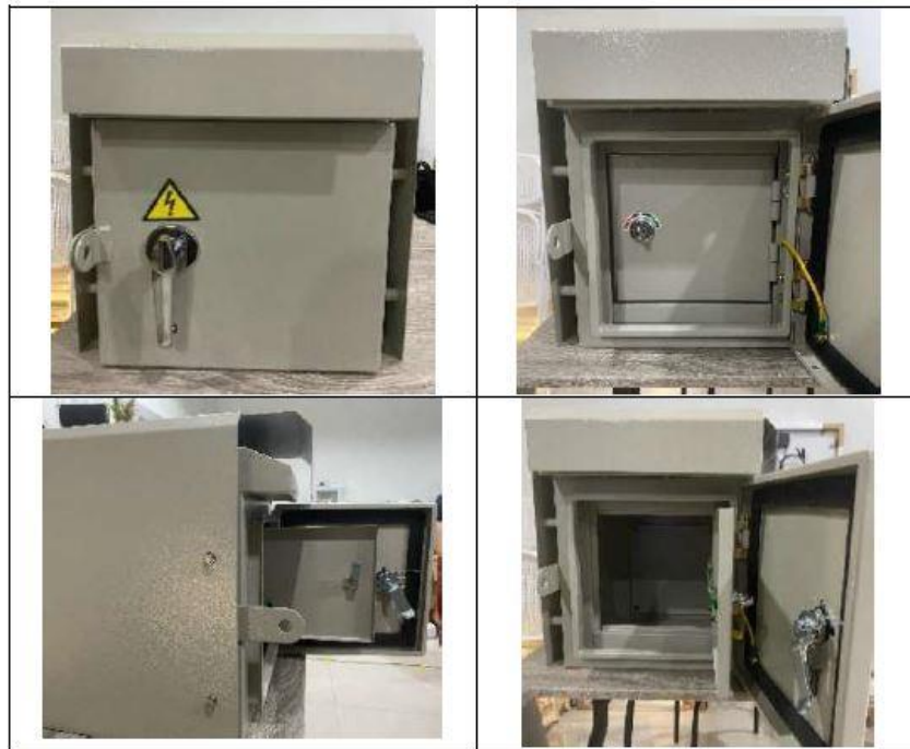
รูปที่ 4.5 ตู้ Outdoor สำหรับติดตั้งเครื่องบันทึกระดับน้ำอัตโนมัติ
