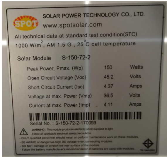
รูปที่ 3.3-1 คุณสมบัติทางไฟฟ้าของแผงโซลาร์เซลล์ขนาด 150 และ 300 วัตต์ ที่ติดตั้งในโครงการพัฒนาแหล่งน้ำบาดาลเพื่อการเกษตรรูปแบบที่ 3
