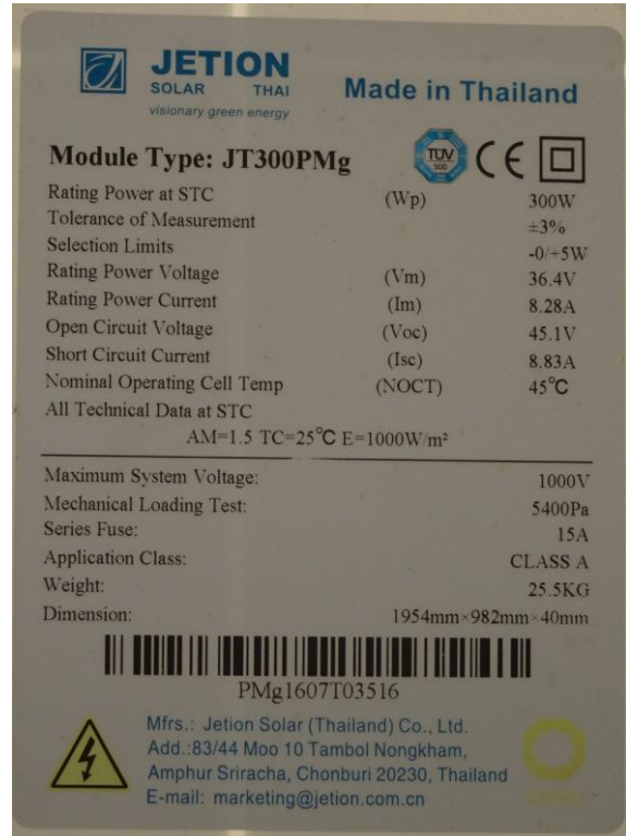
รูปที่ 3.3-1 คุณสมบัติทางไฟฟ้าของแผงโซลาร์เซลล์ขนาด 150 และ 300 วัตต์ ที่ติดตั้งในโครงการพัฒนาแหล่งน้ำบาดาลเพื่อการเกษตรรูปแบบที่ 3
