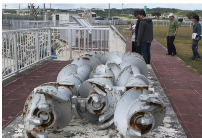
รูปที่ 2 หัวเจาะสามแกน (Tri-Axial drill bit) ที่ใช้ในการสร้างเขื่อนใต้ดิน
