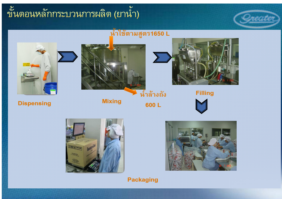
รูปที่ B3.3 กระบวนการผลิตยาน้ำ
