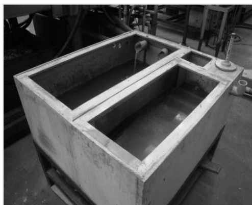
รูปที่ C3.7 แนวคิดและการปรับปรุงระบบเพื่อนำน้ำจากอ่างล้างลวดกลับไปใช้ซ้ำ
