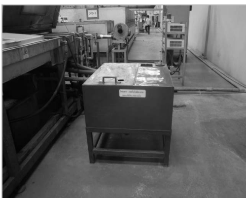
รูปที่ C3.7 แนวคิดและการปรับปรุงระบบเพื่อนำน้ำจากอ่างล้างลวดกลับไปใช้ซ้ำ
