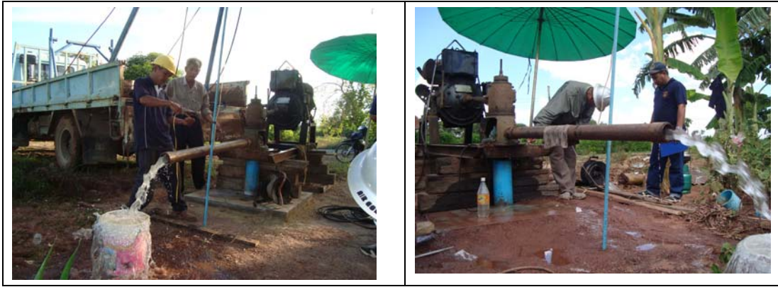
รูปที่ 3-7 การสูบน้ำทดสอบปริมาณน้ำบาดาล
