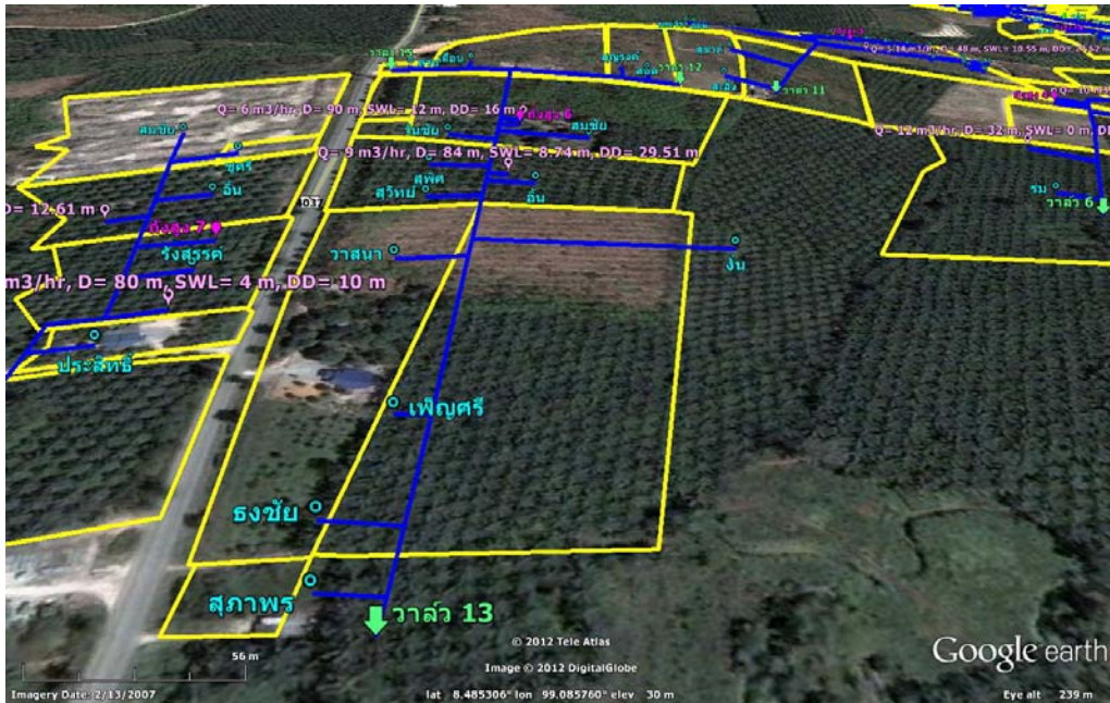
(9) จุดที่ตั้งบ่อน้ำบาดาล ถึงสูง แนวท่อ วาล์วควบคุมหลัก และผู้รับประโยชน์ พื้นที่ย่อย 6
