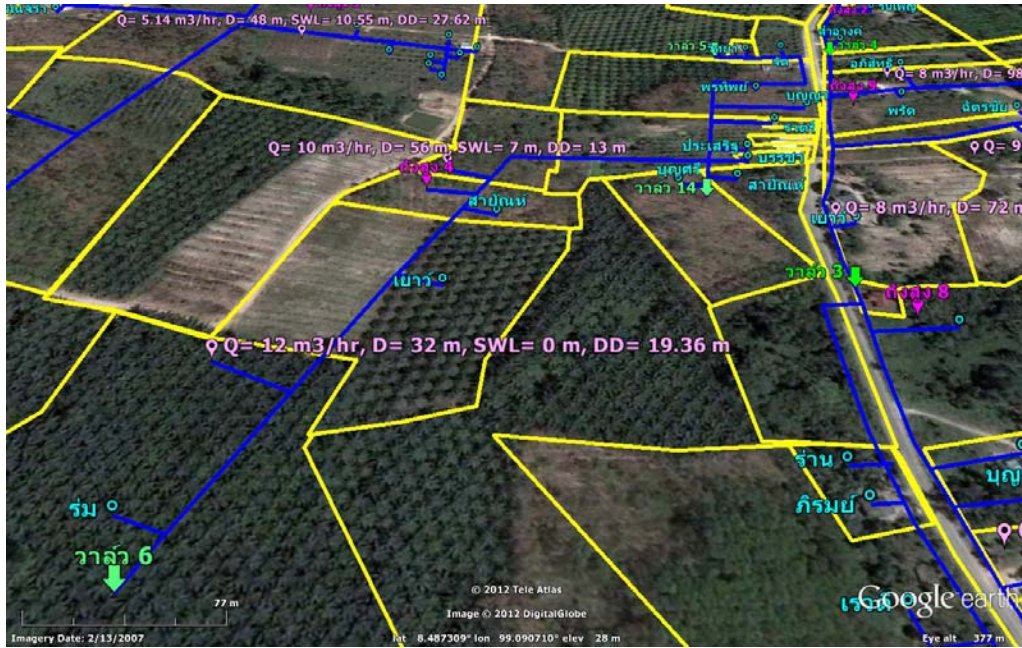
(7) จุดที่ตั้งบ่อน้ำบาดาล ถึงสูง แนวท่อ วาล์วควบคุมหลัก และผู้รับประโยชน์ พื้นที่ย่อย 4
