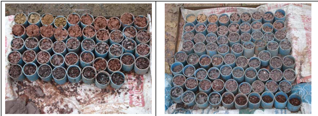
รูปที่ 3-6 ภาพตัวอย่างเศษดิน-หิน ที่ได้จากการเจาะบ่อน้ำบาดาล
