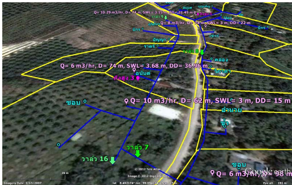
(6) จุดที่ตั้งบ่อน้ำบาดาล ถึงสูง แนวท่อ วาล์วควบคุมหลัก และผู้รับประโยชน์ พื้นที่ย่อย 3
