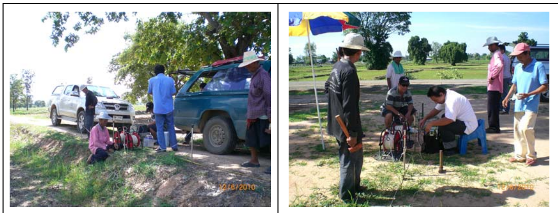
รูปที่ 3-4 การสำรวจธรณีฟิสิกส์ด้วยวิธีวัดความต้านทานไฟฟ้าแบบหยั่งลึก
