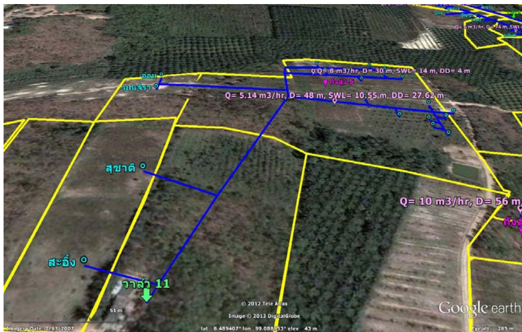
(8) จุดที่ตั้งบ่อน้ำบาดาล ถึงสูง แนวท่อ วาล์วควบคุมหลัก และผู้รับประโยชน์ พื้นที่ย่อย 5
