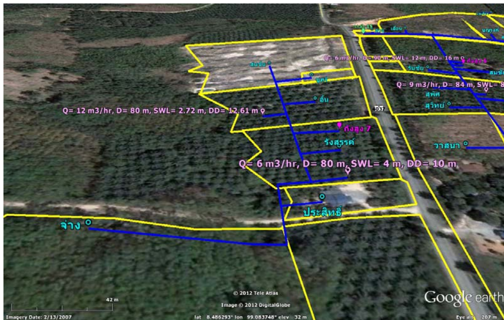
(10) จุดที่ตั้งบ่อน้ำบาดาล ถึงสูง แนวท่อ วาล์วควบคุมหลัก และผู้รับประโยชน์ พื้นที่ย่อย 7
