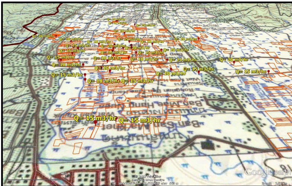
(ข) จุดที่ตั้งบ่อน้ำบาดาล และพื้นที่รับประโยชน์มองทางทิศใต้
