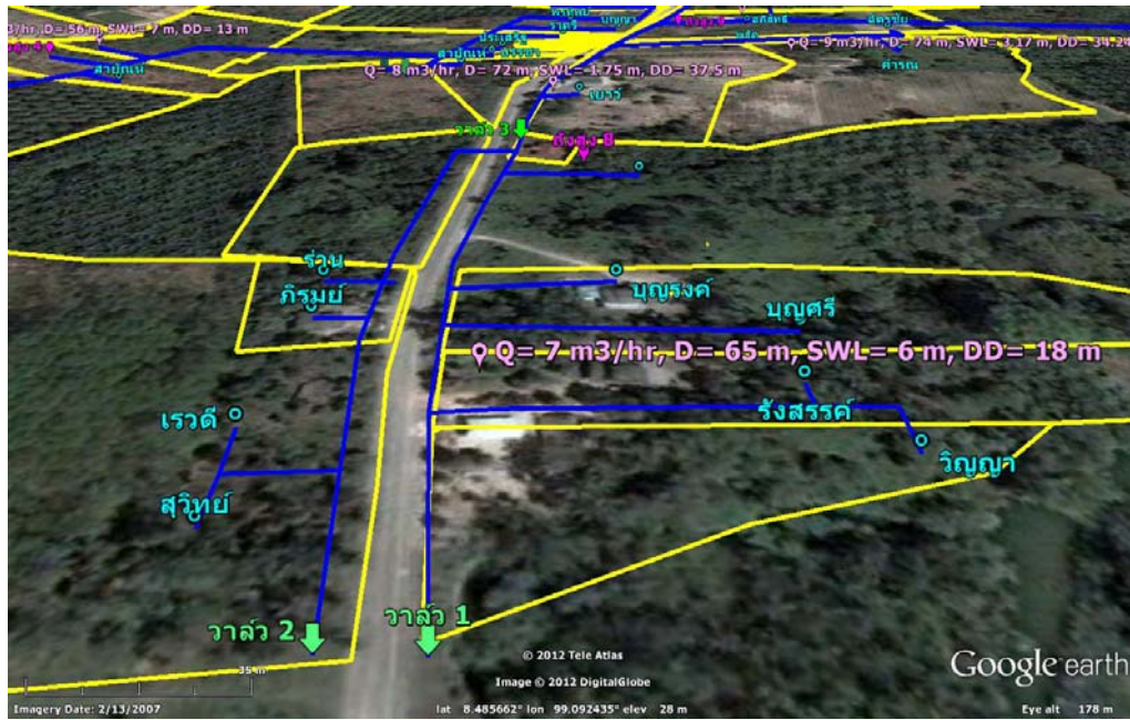
(11) จุดที่ตั้งบ่อน้ำบาดาล ถ้ำสูง แนวท่อ วาลัวควบคุมหลัก และผู้รับประโยชน์ พื้นที่ย่อย 8
