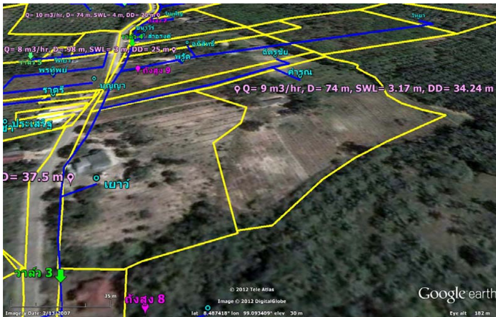
(12) จุดที่ตั้งบ่อน้ำบาดาล ถ้ำสูง แนวท่อ วาลัวควบคุมหลัก และผู้รับประโยชน์ พื้นที่ย่อย 9
