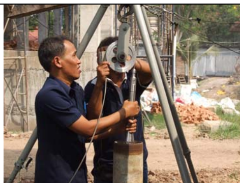
นำกล้องหย่อนลงในบ่อฯ โดยมีสามขาเป็นตัวรับ
