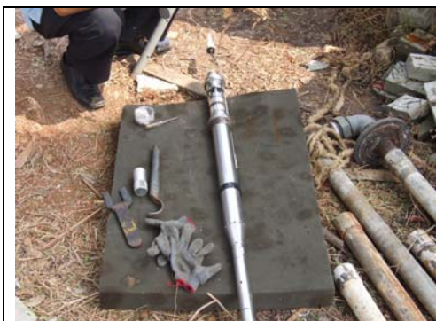
ตัวกล้องโทรทัศน์วงจรปิด (TV-Bore Hole)
