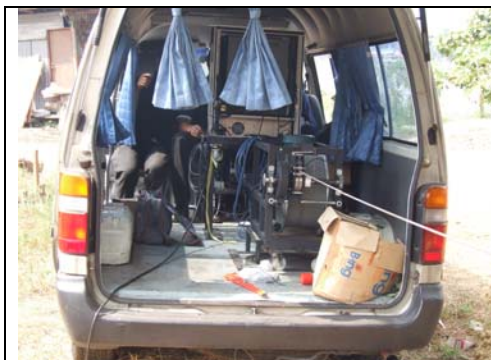
บนรถจะมีรถสำหรับหย่อนกล้องลงในบ่อ
