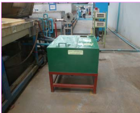
รูปที่ C3.7 แนวคิดและการปรับปรุงระบบเพื่อนำน้ำจากอ่างล้างลวดกลับมาใช้
