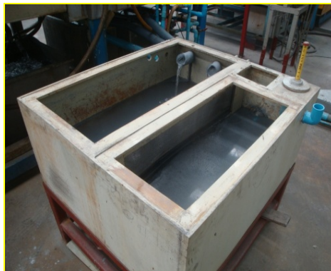
รูปที่ C3.7 แนวคิดและการปรับปรุงระบบเพื่อนำน้ำจากอ่างล้างลวดกลับมาใช้
