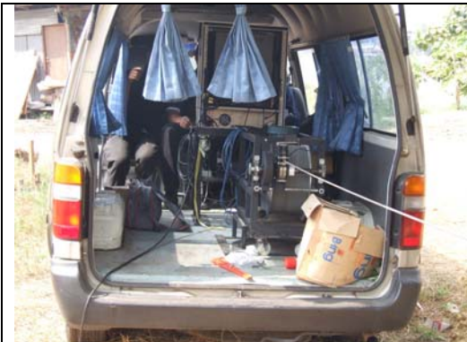
บณรถจะมีรถสำหรับหย่อนกล้องลงในบ่อ
