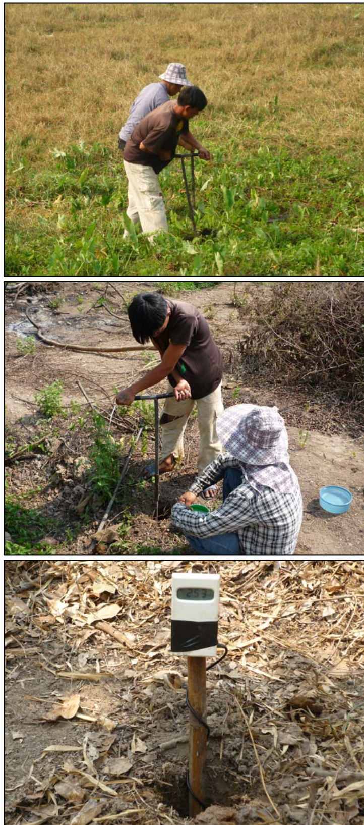
รูปที่ 4.24 การเจาะหลุมระดับต้นเพื่อวัดอุณหภูมิ
