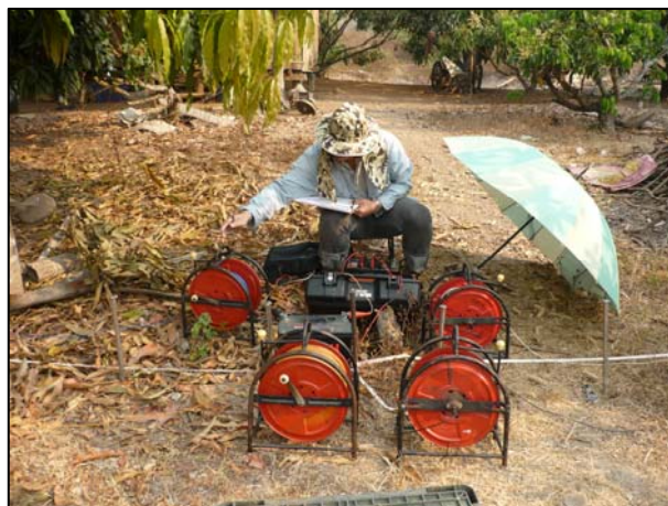
รูปที่ 4.17 การสำรวจภาคสนามด้านความต้านทานไฟฟ้าจำเพาะ
