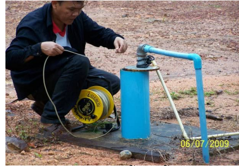
ข. การวัดระดับน้ำบ่อน้ำบาดาล
