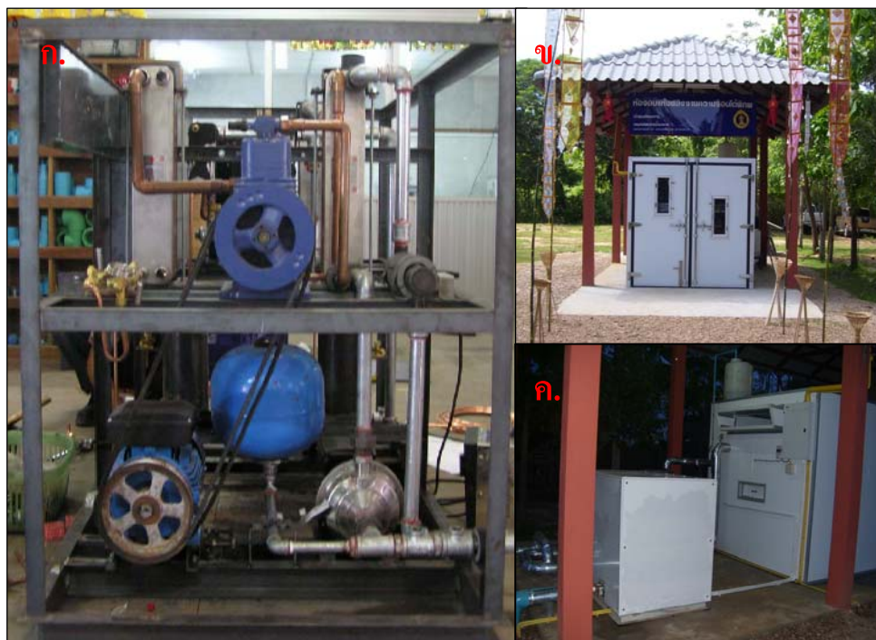
รูปที่ 8 ระบบ 2 Stage Geothermal heat pump และห้องอบแห้ง (ก. ระบบ 2 Stage Geothermal heat pump ก่อนทำการทดสอบเบื้องต้น ข. ด้านหน้าต้นแบบห้องอบแห้งระบบ 2 Stage Geothermal heat pump ค. ด้านหลังต้นแบบห้องอบแห้งระบบ 2 Stage Geothermal heat pump)
