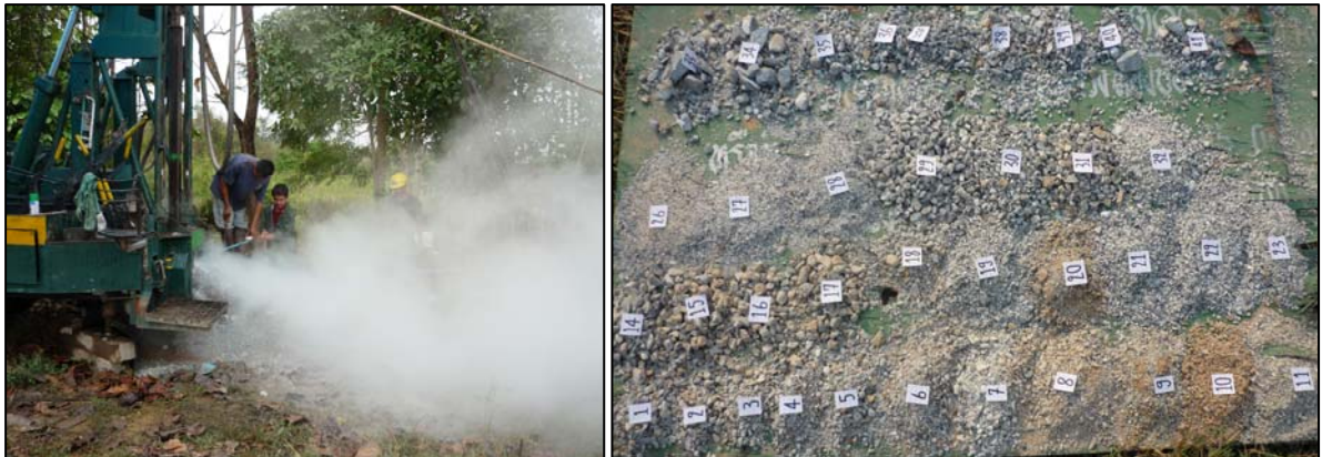
รูปที่ 2 การเจาะหลุมสำรวจ และ เศษหินตัวอย่าง (cutting)
