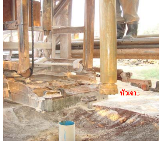
(ข) หัวเจาะแบบกดกระแทก (DHH) ขนาด 6 นิ้ว
