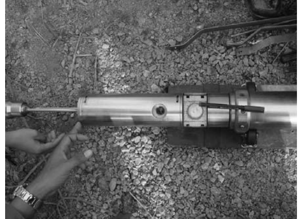
(ข) ตำแหน่งของกล้องโทรทัศน์ บริเวณตอนปลายของ เครื่องมือเพื่อถ่ายภาพจากมุมมองด้านบน (top view) และด้านข้าง (side view)
