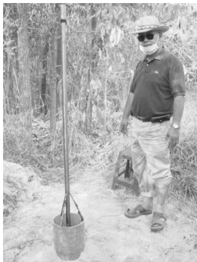
(ก) เครื่อง caliper log และวงแหวนเหล็ก ขนาดเส้นผ่าศูนย์กลาง 4.5 และ 7 นิ้ว
