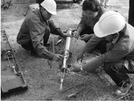
(ก) การเตรียม television log และตรวจสอบสภาพ เครื่องมือก่อนหยั่งในหลุมเจาะ
