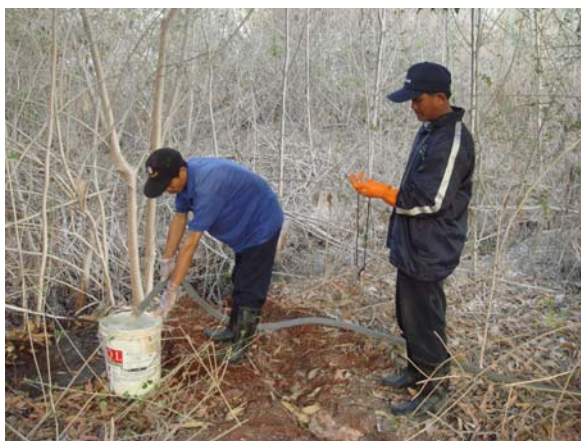
(จ) การวัดปริมาณการสูบน้ำจากการสูบน้ำทดสอบ
