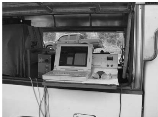
(ง) อุปกรณ์ที่ใช้ในการบันทึกและประมวลผล การหยั่ง caliper log
