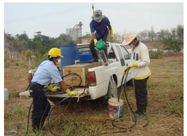
(ฉ) การทำความสะอาดอุปกรณ์ภายหลังการสูบน้ำทดสอบ
