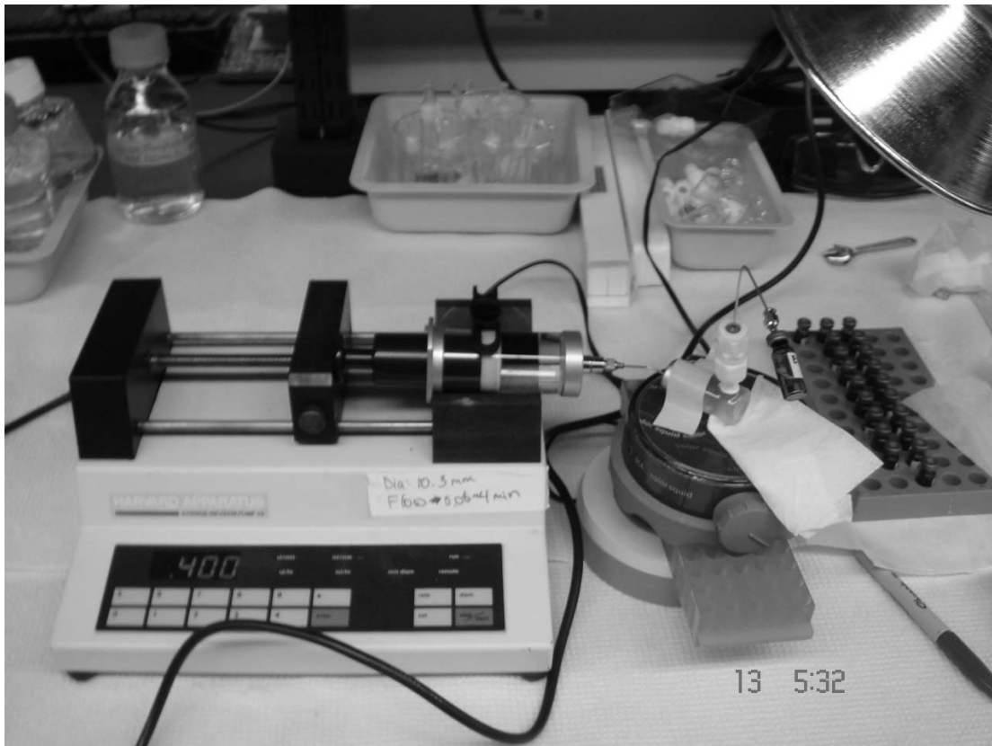
รูปที่ 7-14 ระบบชุดทดลองที่พัฒนาขึ้นสำหรับดำเนินการทดสอบประสิทธิภาพของเทคนิค PITT
