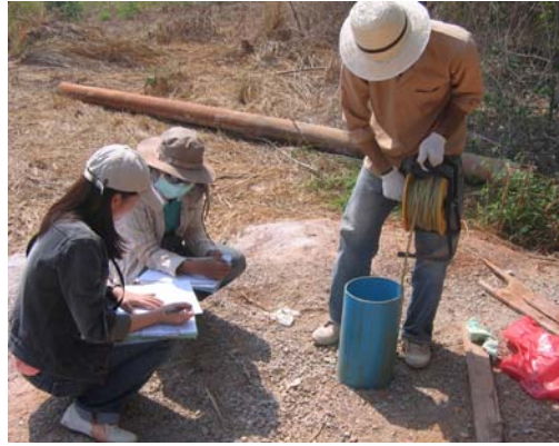
รูปที่ ๕-3 การวัดระดับน้ำจากบ่อสังเกตการณ์
