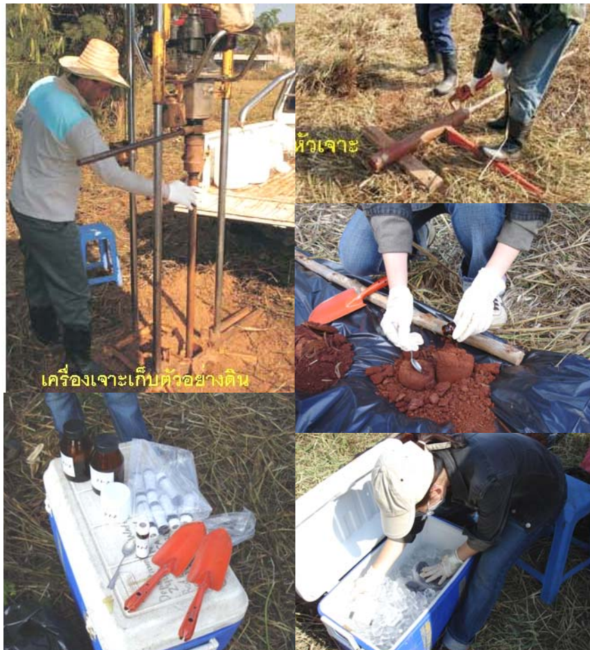
รูปที่ ๕-1 อุปกรณ์และขั้นตอนในการเก็บตัวอย่างดิน
