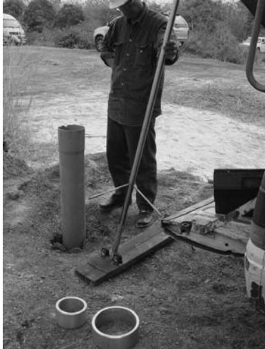
(ก) เครื่อง caliper log และวงแหวนเหล็ก ขนาดเส้นผ่าศูนย์กลาง 4.5 และ 7 นิ้ว
