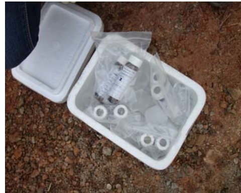
รูปที่ ๕-7 การเก็บรักษาตัวอย่างที่อุณหภูมิ 4\pm 2^{\circ}\text{C} ก่อนนำส่งห้องปฏิบัติการ
