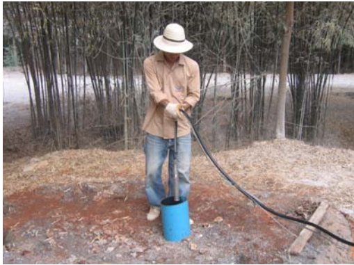
รูปที่ ๕-4 การหย่อน submersible pump เพื่อเก็บตัวอย่างน้ำ
