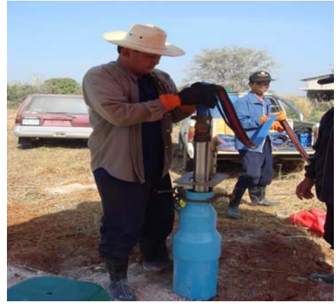
(ข) submersible pump ที่ใช้สูบน้ำทดสอบแบบ slug test
