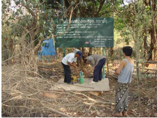
(ก) การวัดระดับน้ำจากบ่อประปาบาดาลหมู่บ้าน
